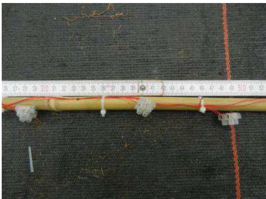
**Abbildung 12: Anbringung der Messfühler an Bambusrohr**
