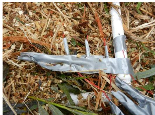
Abbildung 23: Temperaturfühler am Wärmeübertragerrohr
