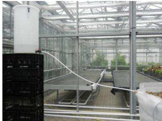
**Abbildung 15: Wasserbehälter mit Zulaufleitung**
