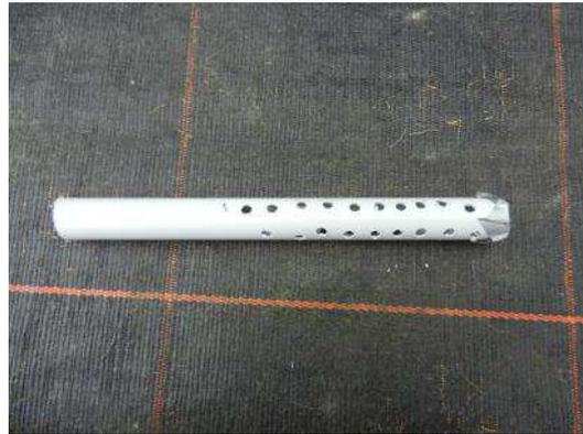
**Abbildung 17: Belüftungsrohre**
