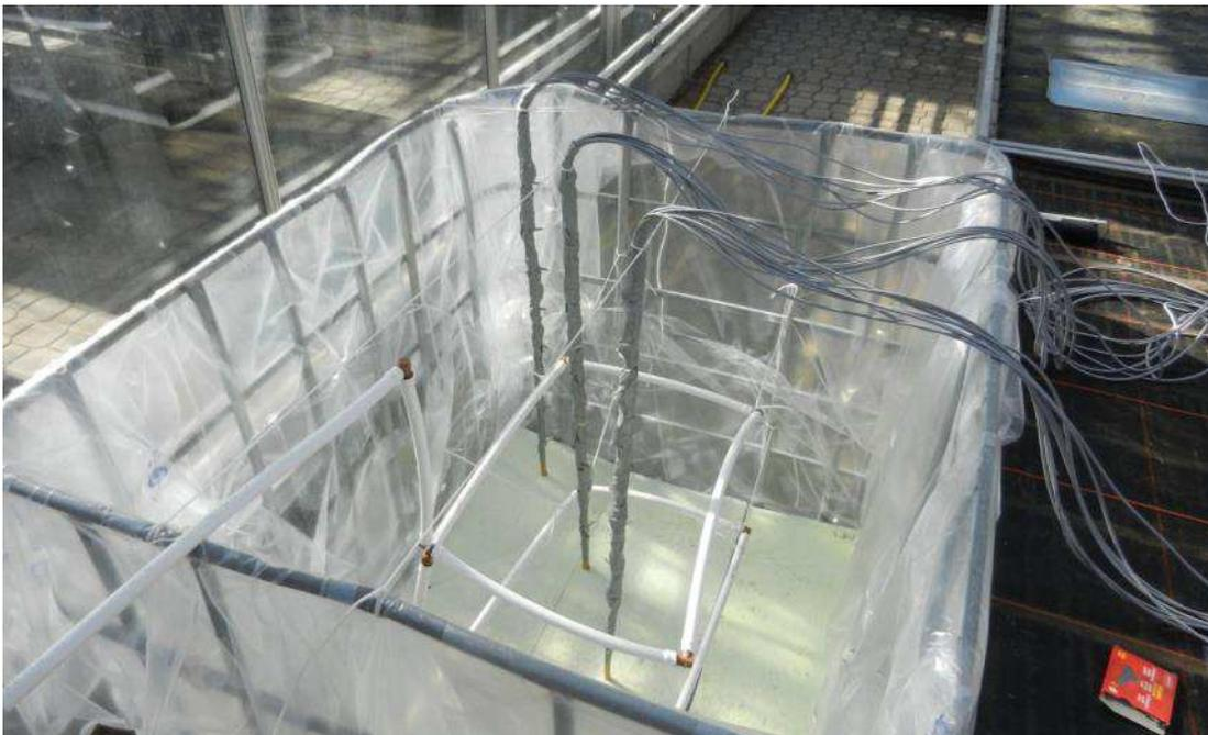
Abbildung 14: Modell-Biomeiler mit Wärmeübertrager und Messstäben
