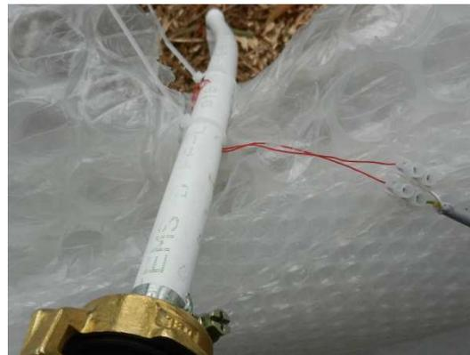
**Abbildung 25: Temperaturfühler Wärmeübertragereingang**
