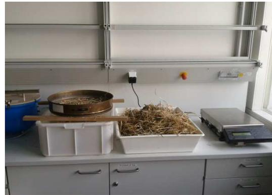
**Abbildung 27: Siebanalyse nach DIN 18123**
